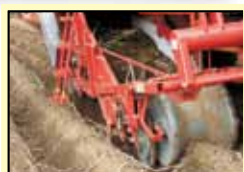
トラクターが走行する横の畦を掘取るため、畦を踏むことがなく、損傷を防ぎます。
