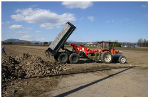
石を排出しやすいようにダンフ部分を改造されています。スゴイ!!
