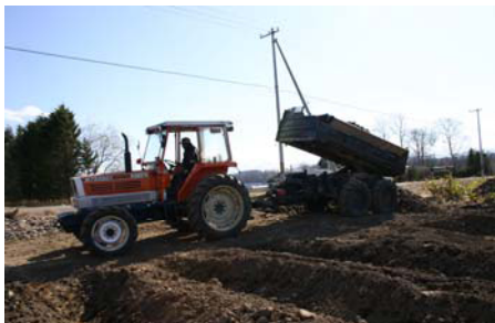
石を排出しやすいようにダンフ部分を改造されています。スゴイ!!
