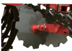
20インチの整地ディスクは表層部の土と残渣物との混和・整地を行うとともに、チゼル通過によって掘り起こされた土の余分な飛散を抑制します。整地ディスクの高さ調整は、機体を持ち上げた状態で調整ハンドルを回すことによって手軽に行えます。
