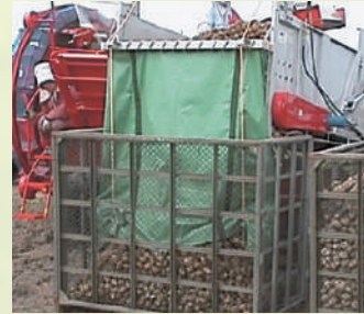
② 袋を徐々に下げ、シュートの下部を解放しコンテナへ排出。
